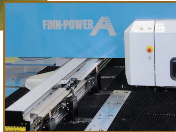
Um terceiro grampo de chapas junto com o PCS possibilita o movimento do grampo durante o programa. Característica que elimina zona morta e permite ser utilizado até 100% do material.
