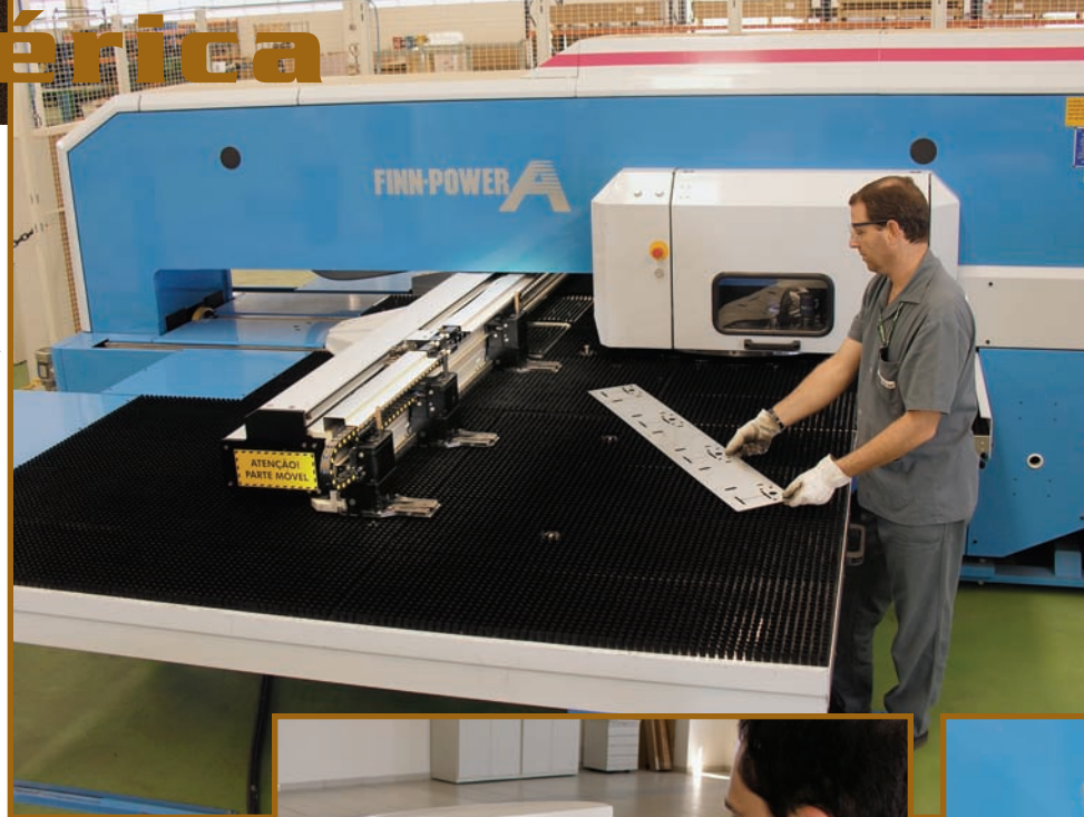
Mesas de Escovas são padrão em todas as puncionadeiras de torreta da Finn-Power e proporcionam melhor suporte do material durante o puncionamento, redução de ruído e de marcas na superfície da chapa.
