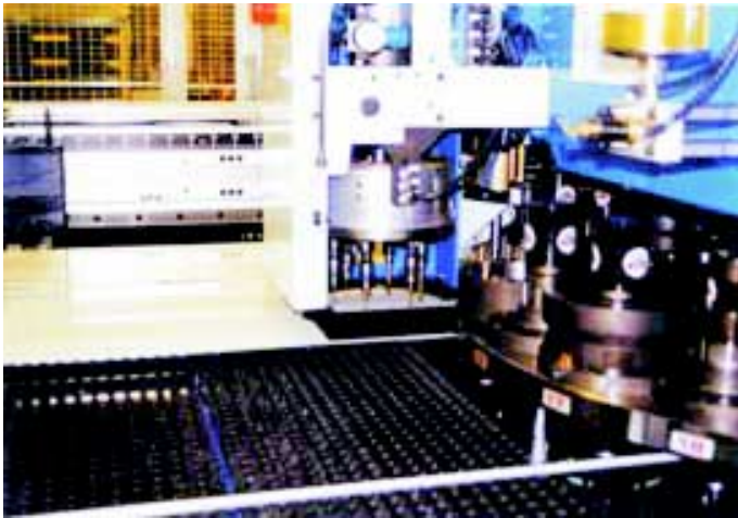
Bild 2: Laser/Stanz-Maschine LPE 5 von Finnpower mit dem servoelektrischen Stanzkopf mit Revolvermagazin für 20 Stationen im Vordergrund und der Gewindeformeinheit im Hintergrund
