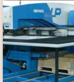
Fig. 4 – Combinação de laser /puncionamento
