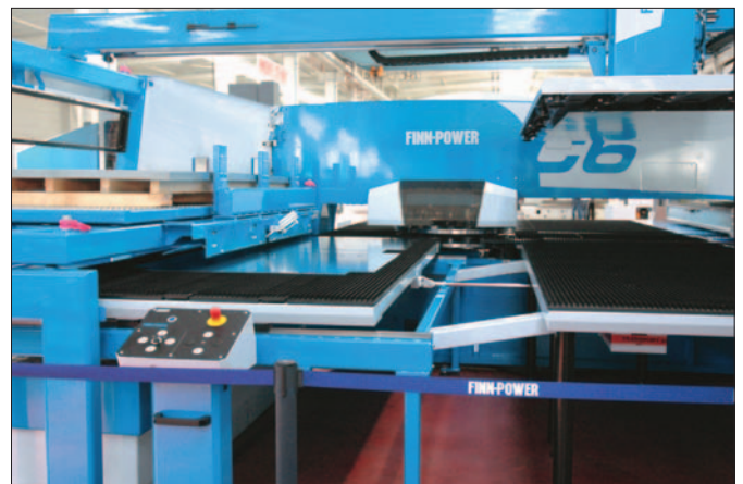
◆ Opération de déchargement et rechargement sur la C6 Compact Express. L'évacuation du flan poinçonné est réalisée alors même qu'un nouveau est prêt à être placé sur la table.
